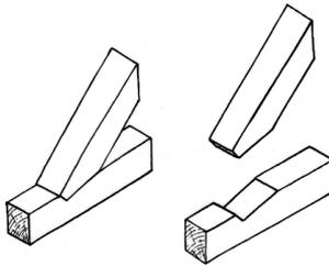
Fig. 2 Oblique step joint [23]
